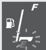
**Si el indicador de combustible parpadea con un patrón repetitivo o se apaga:**
